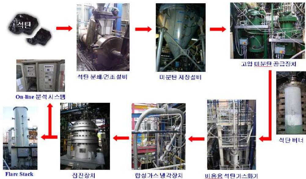
[그림 1] Pilot급 비용융 방식 석탄가스화기 시스템 구성도
