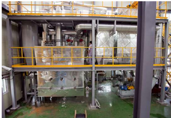
[그림 3] 당진화력에 설치된 파일럿 규모 (10톤/일) 연속식 유동층 석탄 건조 시스템.
