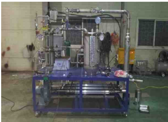
Fig. 1. 2단 침수형 연소 증발기 (왼쪽)와 증발기 내부 온도 (오른쪽)
