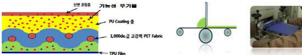
<난연 특성의 유해물질 차폐용 직물 구조 & Knife over-roll 코팅 방식>
