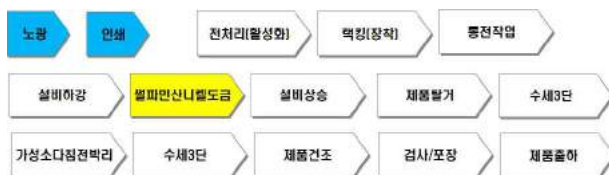
그림1. Screen Micro Mesh 제조공정도
