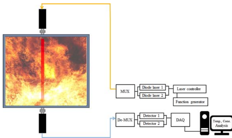
< 연소로 내 TDLAS를 이용한 온도/농도 계측 구성도 >
